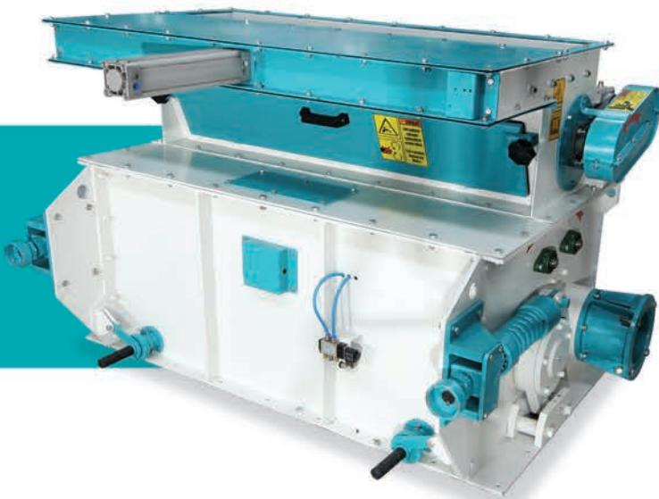
Büyük granül ve peletlerin kırılmasını ve istenilen ebatlarda yem elde edilmesini sağlar.
