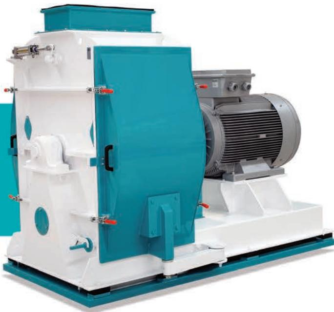
Ceşitli sertliklerde yem komponentlerinin öğütülmesi ve elenmesinde etkin bir çözüm, geniş ve özel dizayn edilmiş kapak açma sistemi, menteşeli kapılar sayesinde öğütme bölümüne kolay ve güvenli ulaşım.
